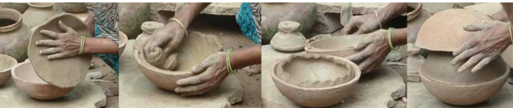
Figura 24 – Moldeado en molde convexo (Uttar Pradesh, India)
