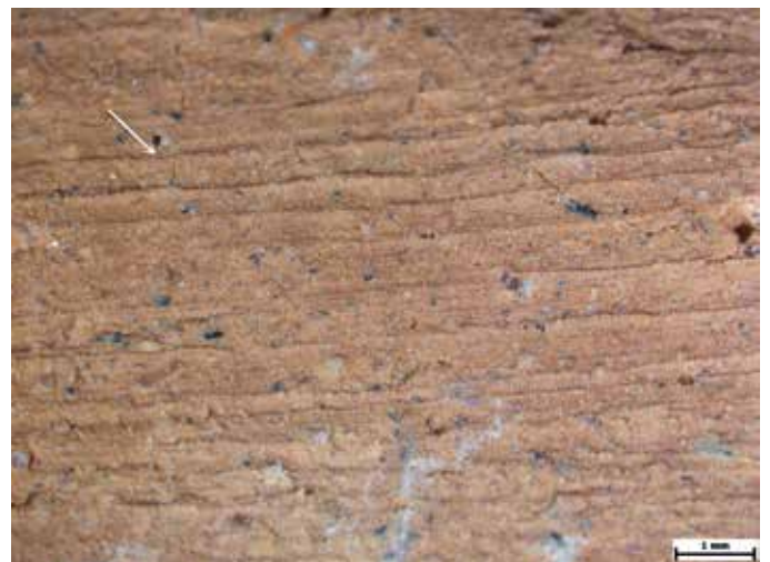
Figura 44 – Microtopografía fluidificada o irregular con granos salientes y estrías concéntricas paralelas con bordes nervados
