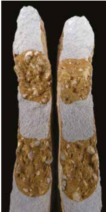
Figura 8 – Junturas horizontales y en U obtenidas por pinchado según gestos poco sistematizados
