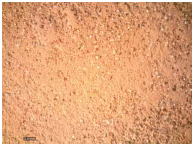
Figura 32 – Antiadhesivo (arena) en la pared en contacto con el molde (percusión)
