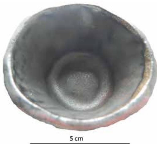
Figura 19 – Concavidad central (fondo del recipiente)
