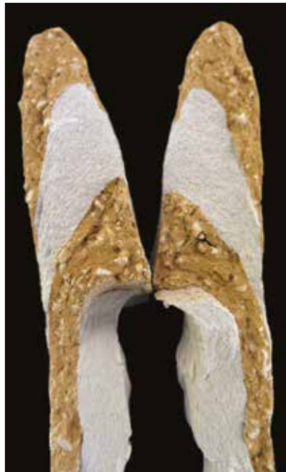
Figura 9 – Junturas oblicuas obtenidas por aplastado
