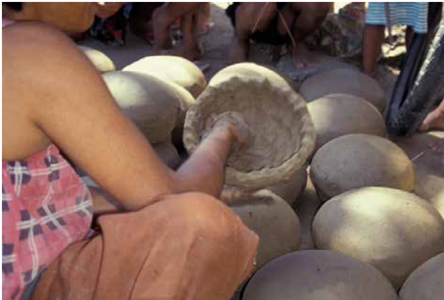
Figura 35 – Martillado sin herramienta (Cebu, Filipinas)
