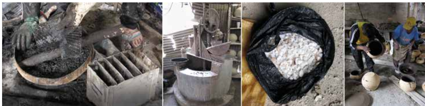
Figura 118 – Fabricación de vidriado a base de plomo extraído de baterías usadas y mezclado con cuarzo (Chordeleg, Ecuador)
