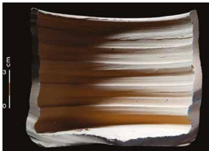
Figura 85 – Ondulaciones en forma de bandas de corte rectangular (no empastadas)
