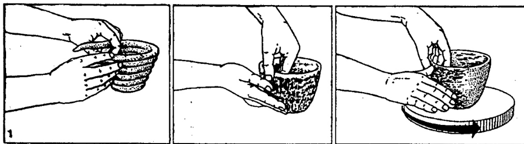
Figura 79 – Método 1: los rollos son colocados, apegados entre sí y adelgazados sin energía cinética rotativa y luego conformados con ella
