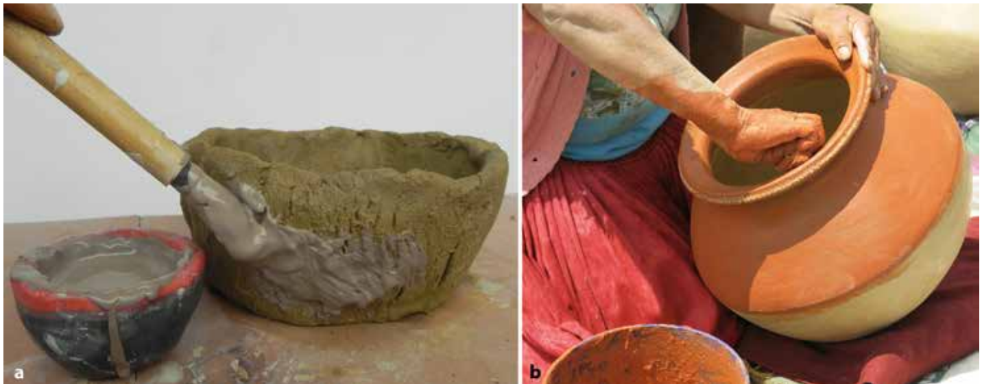
Figura 112 – Tratamiento de superficie por enlucido. a: barbotina; b: engobe (San Miguel de Porotos, Ecuador)
