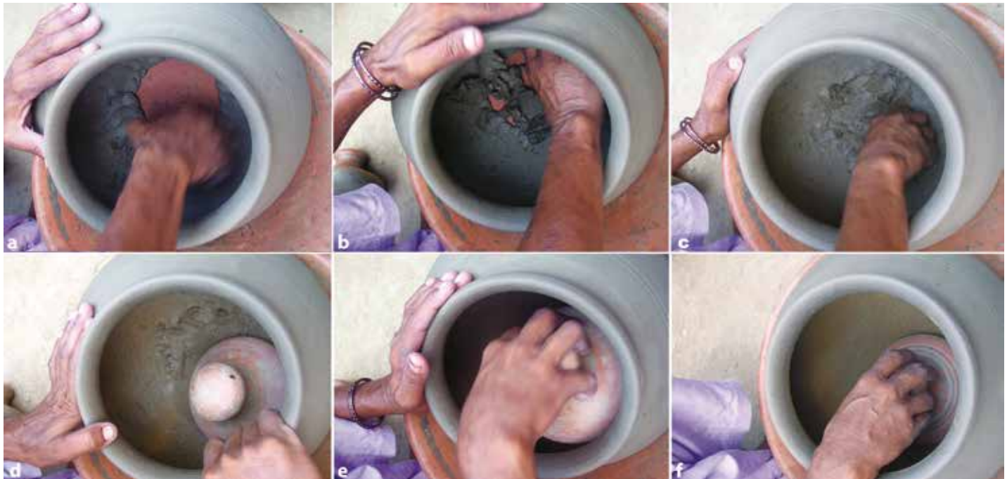
Figura 65 – Martillado aplicado a recipientes sin fondo y conformados sobre pasta coriácea por presiones discontinuas centrípetas (Uttar Pradesh, India)
