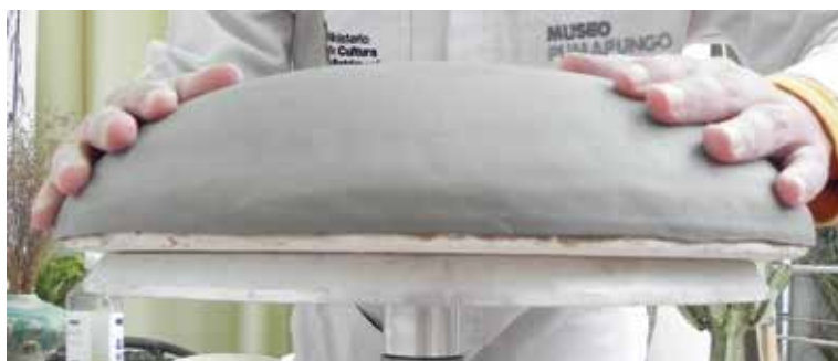
Figura 25 – Moldeado en molde cóncavo
