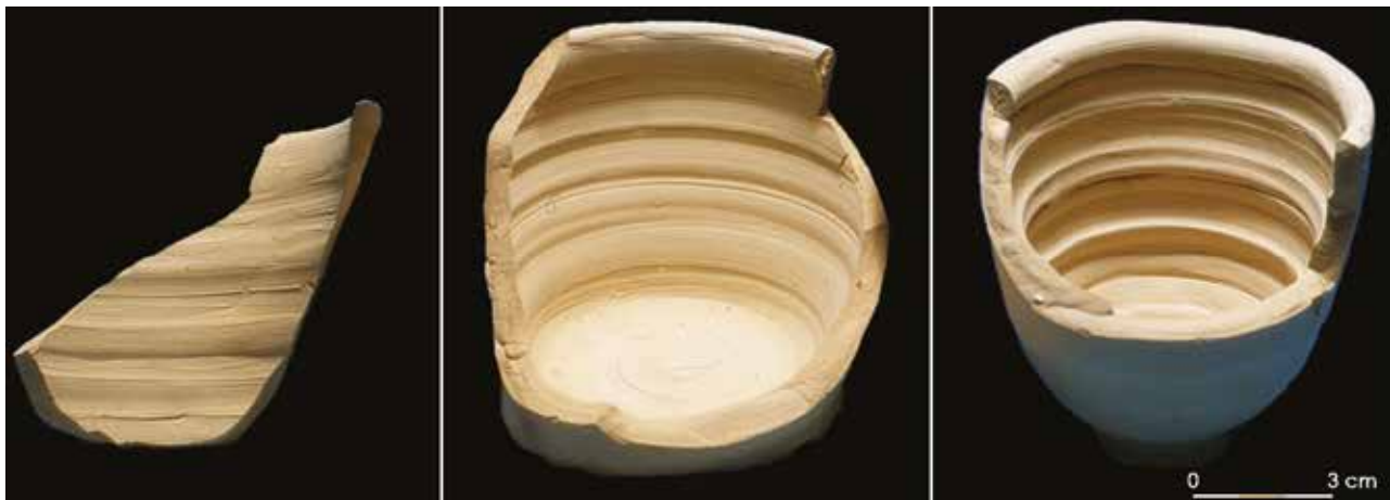
Figura 90 – Gran diversidad de ondulaciones, entre las cuales se observan bandas atravesadas por fisuras curvilíneas
