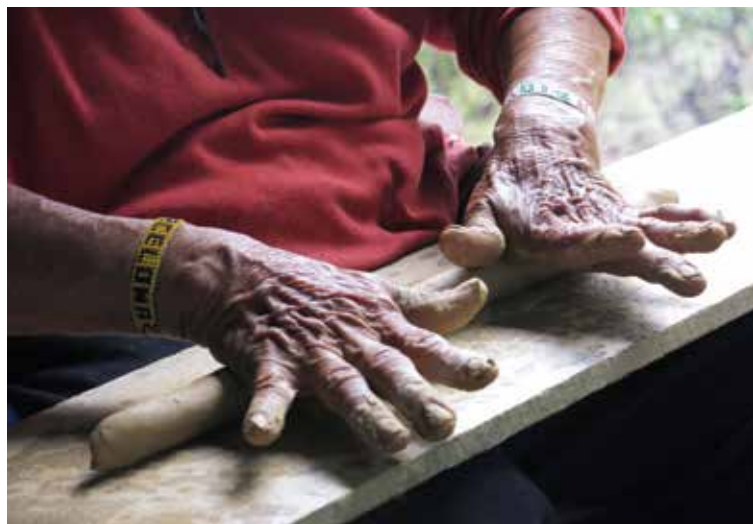
Figura 2 – Formación del rollo sobre la superficie de trabajo
